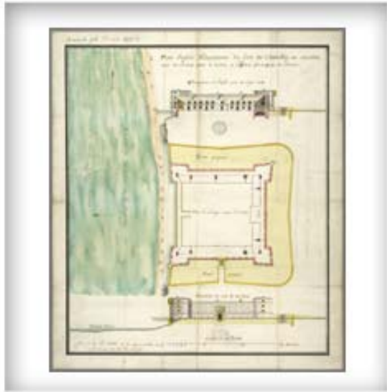
Plan, profils et élévations du fort de Chambly en Canada avec les projets de le mettre en deffence marqués en jaune, fait à la Rochelle ce 18 novembre 1718. FR CAOM 3DFC 499B
